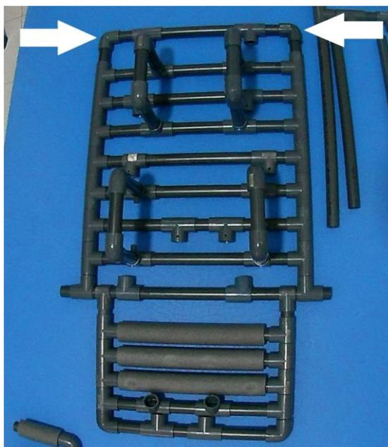
En el tubo de unión de las 3 partes (respaldo, asiento y soporte posterior) se introducen las "T" que hemos cortado y/o fresado con anterioridad:
