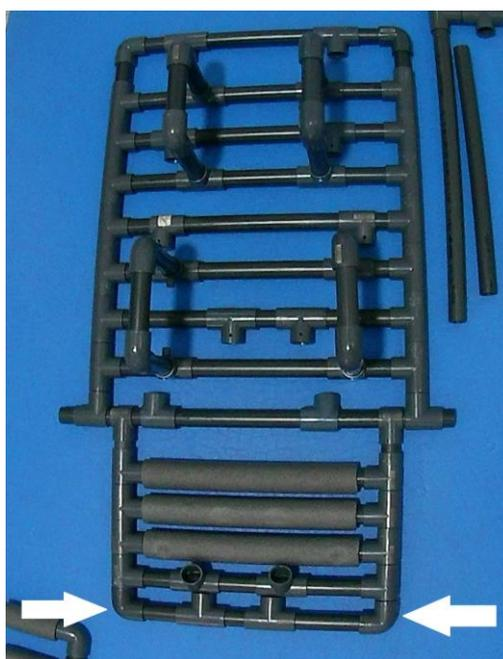
Aunque antes de ensamblarlo introducimos en los tubos horizontales del asiento las coquillas (en los tres tubos superiores [1]) y las "T" fresadas, pero no cortadas (en los dos tubos inferiores [2]).
