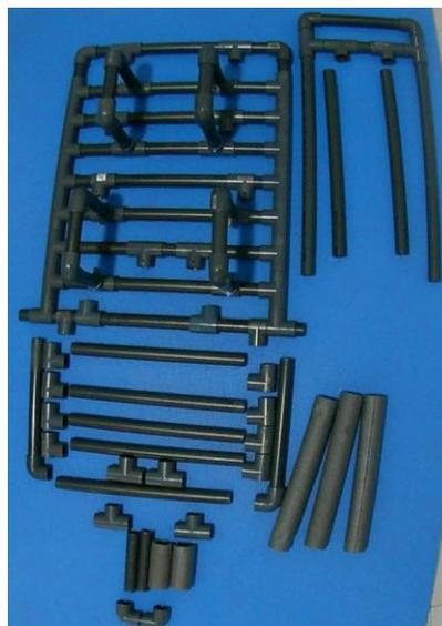
En cada tubo horizontal del respaldo debemos insertar dos "T" que se usarán o para poner los controles de tronco y de cabeza y el soporte posterior.
